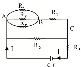
$$P = P_{(R_{eq})} = R_{eq} I^2 = \frac{3}{2} R I^2 \quad \text{خروجی باتری}$$
